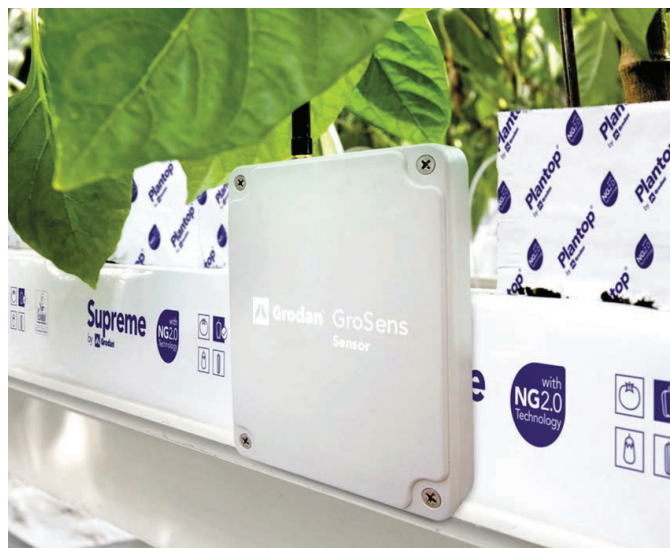
Rysunek 1.0 Sensor GroSens umieszczony w macie uprawowej z wełny skalnej.
