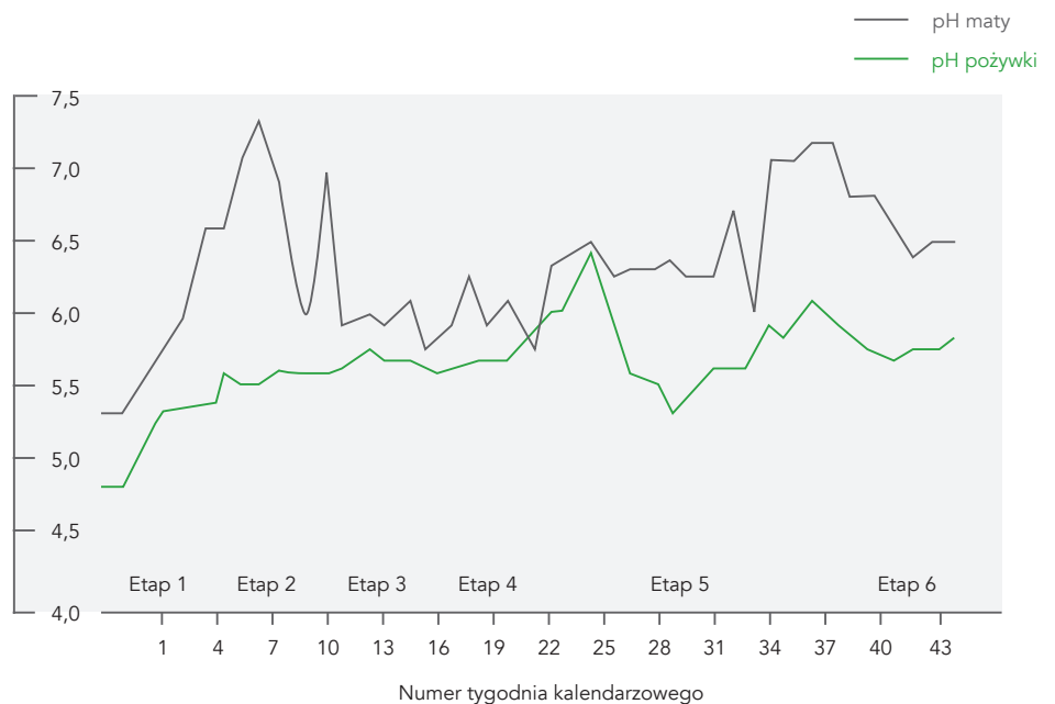
rys. 3 Reakcja pH pożywki i maty podczas cyklu uprawy pomidora na wełnie skalnej.
